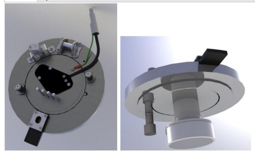
Figure 7-9. Glow discharge insert
